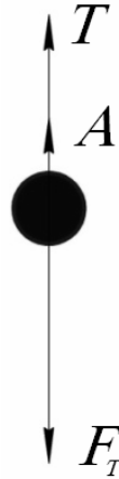
Рис. 1 – Силний вплив на краплю розплаву, яка вилітає з отвору гранулятора в об'ємі грануляційної вежі
